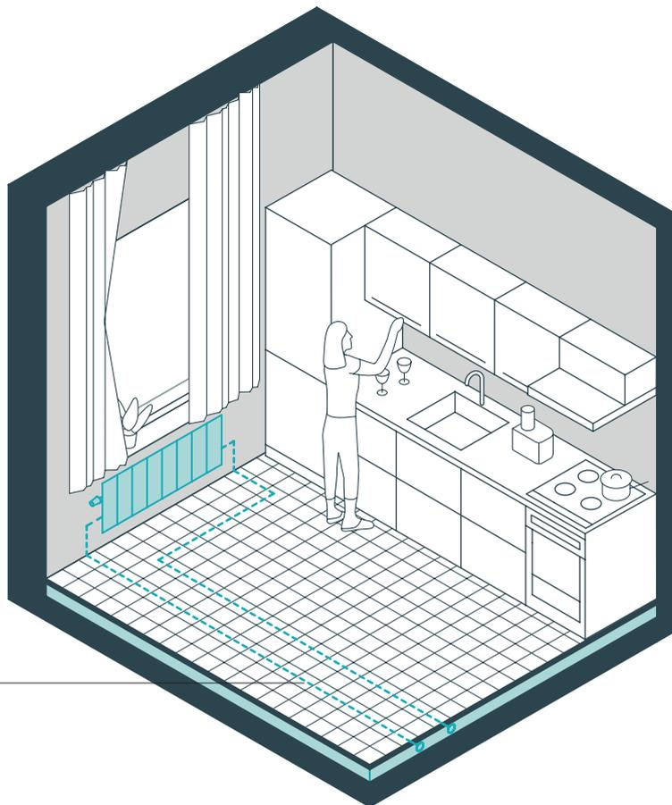
Трубы, подведенные к прибору в стяжке пола, могут выполнять и функцию теплого пола
