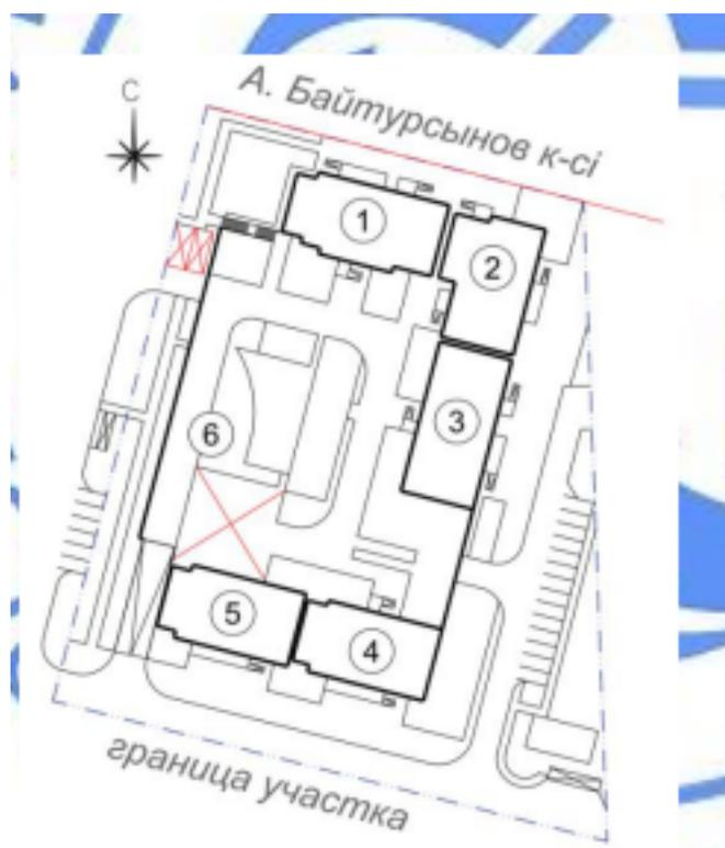
Размещение и ориентация жилых зданий, обеспечивает нормативную продолжительность инсоляции жилых помещений и территории в соответствии с нормами проектирования. На территории размещены два отдельно стоящих жилых дома, состоящих из трех блоков (12, 9, 9 этажей) и из двух блоков (9, 9 этажей) со встроенными помещениями общественного назначения, и пристроенный к домам одноэтажный паркинг.
